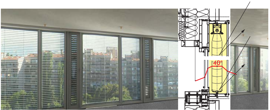
Abb. 32: Die RETRO-Reflexion bei offen gestellter Jalousie in Sofia gewährleistet eine hervorragende, ganzjährige Durchsicht und Tageslichteinflutung bei aktivem Sonnenschutz. Das im Fassadenschnitt eingetragene Temperaturprofil entsteht bei einer Einstrahlung von ca. 500 W.
